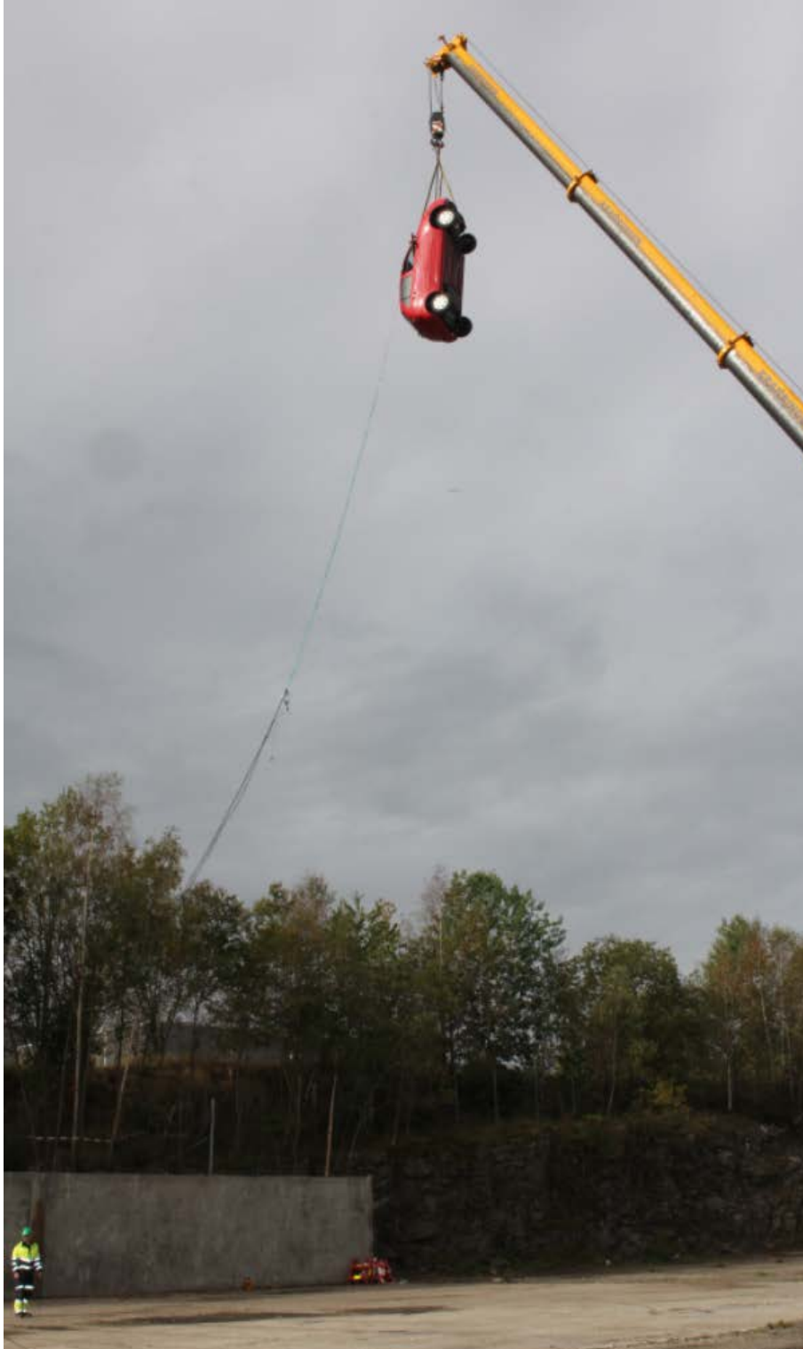
Figur B-1 Bilde tatt før testen. Bilen er heiset opp med heisekran og henger i ca. 20 meter høyde med bakenden vendende nedover, klar for å bli sluppet i fritt fall mot bakken.
