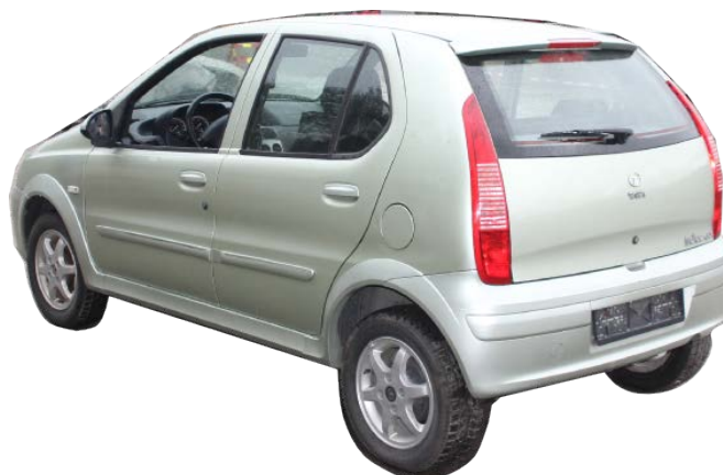
Figur 3-1 Elbilene som ble benyttet var en Tata Indica GLX der bensinmotoren var erstattet med en elektrisk motor og et Li-ion batteri.
