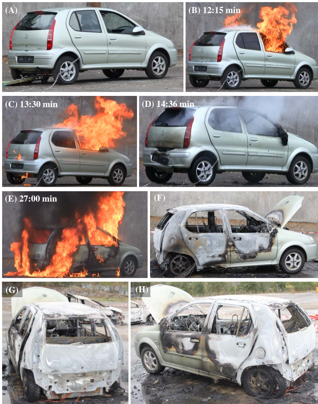
Figur C-1 Bilder tatt før (A), under (B) – (E) og etter (F) – (H) testen. Omtrentlig tidspunkt etter teststart (antennning av propanbrenneren) er angitt i bildene som er tatt under testen. (A) Batteriet varmes med en liten propanflamme fra undersiden. (B) Like etter at propanbrenneren er fjernet, brenner det godt i kupéen. (C) Like før slokkeforsøk 1 iverksettes. (D) Slokkeforsøk 1 er ferdig. (E) Like før slokkeforsøk 2 iverksettes. (F) Bilen ble aktivt slokkes, og med unntak av fronten er bilen nesten utbrent. (G, H) Utbrent bil fra baksiden.
