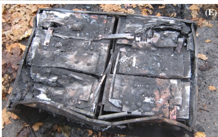
Figur B-3 Bilde (A) – (C) viser bilen fra ulike vinkler ca. 150 minutter etter testen. Brannen har slokket av seg selv, bilen var utbrent og det var fortsatt mange hundre grader i batteripakken. Batteriet ble tatt ut av bilen ca. tre uker etter test, og cellene i de to boksene (D) og (E) som utgjorde batteripakken var fullstendig ødelagte. Øverst i (D) er en komplett modul, mens de andre modulene i bildet er plukket fra hverandre.
