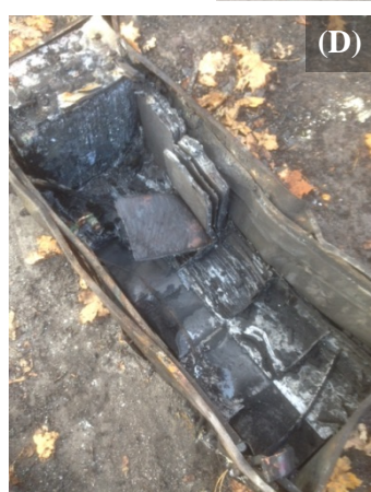
Figur B-3 Bilde (A) – (C) viser bilen fra ulike vinkler ca. 150 minutter etter testen. Brannen har slokket av seg selv, bilen var utbrent og det var fortsatt mange hundre grader i batteripakken. Batteriet ble tatt ut av bilen ca. tre uker etter test, og cellene i de to boksene (D) og (E) som utgjorde batteripakken var fullstendig ødelagte. Øverst i (D) er en komplett modul, mens de andre modulene i bildet er plukket fra hverandre.
