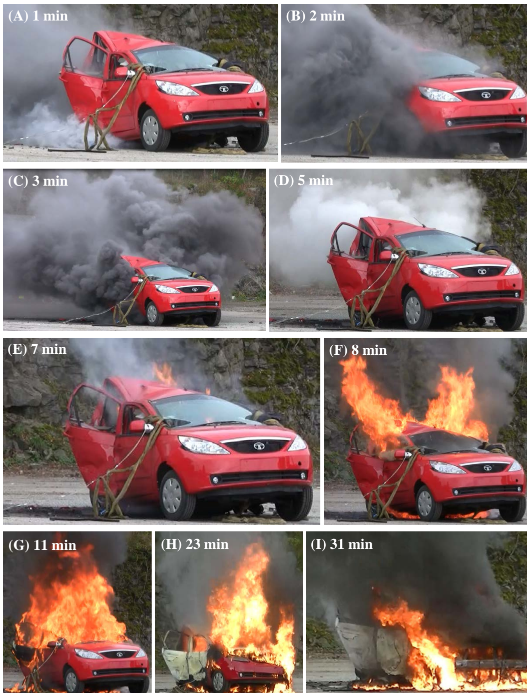
Figur B-2 Bilder tatt under testen. Omtrentlig tidspunkt etter slippet av bilen er angitt i bildene. (A) Betydelig røykproduksjon og gråhvit røyk. (B) Økt røykproduksjonen og mørkere røyk. (C) Kraftig røykproduksjon. (D) Hovedsakelig hvit røyk. (E) Flammer kan observeres og røykmengden er betraktelig redusert, noe som tyder på at en stor del av gassene som produseres fra batteriet brenner opp. (F) Full overttenning i kupéen av bilen. (G) Bilen er i full fyr. (H) Brannen har spredt seg til fronten av bilen. (I) Deler av bilen er fullstendig utbrent, mens det fortsatt brenner godt foran.
