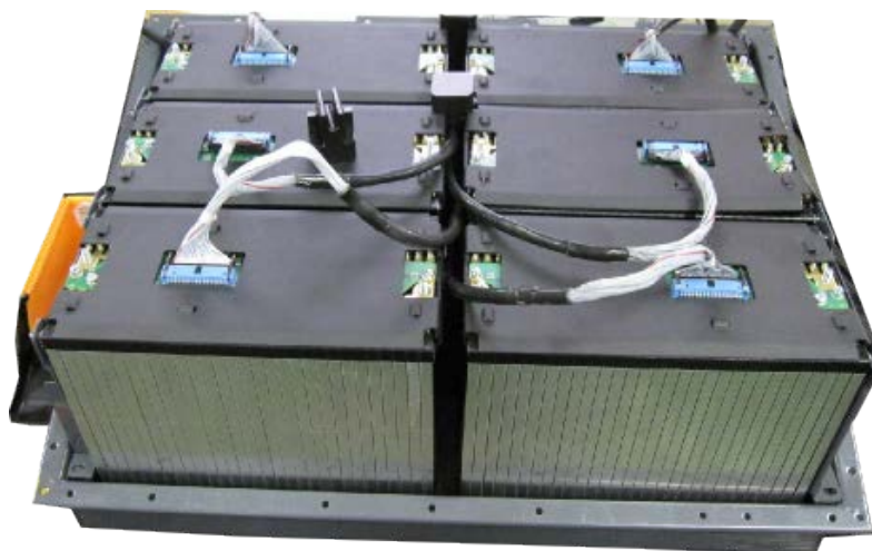
Figur 3-2 Batteriboks bestående av seks batterimoduler. Batteripakken som ble benyttet til elbilene i testene besto av to slike bokser, dvs. totalt 12 moduler. Hver batterimodul besto av 30 poseceller.
